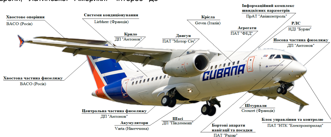
Рис. 4. Схема міжгалузевої кооперації у виробництві вузькофюзеляжних літаків Ан-158
